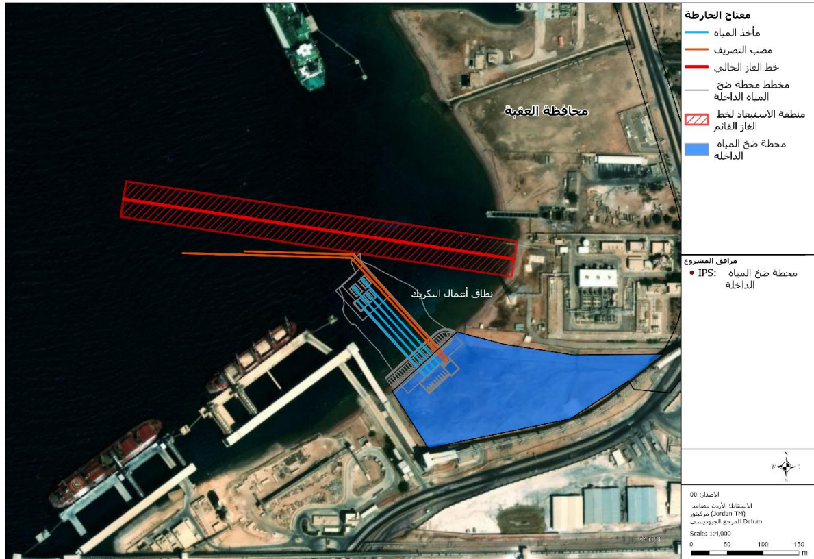
الشكل 1: المخطط التوضيحي لمرافق السحب والتصريف ومحطة ضخ السحب IPS
